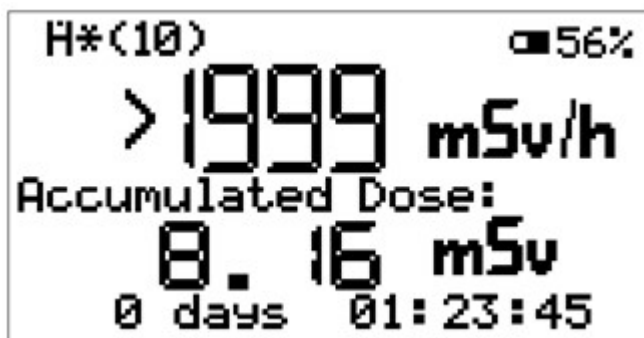
III. 18 a) Affichage dépassement de plage de mesure en mode de mesure « Débit de dose ».
