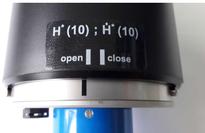
Ill. 14) Arrêt du cavalier de renforcement de paroi.
