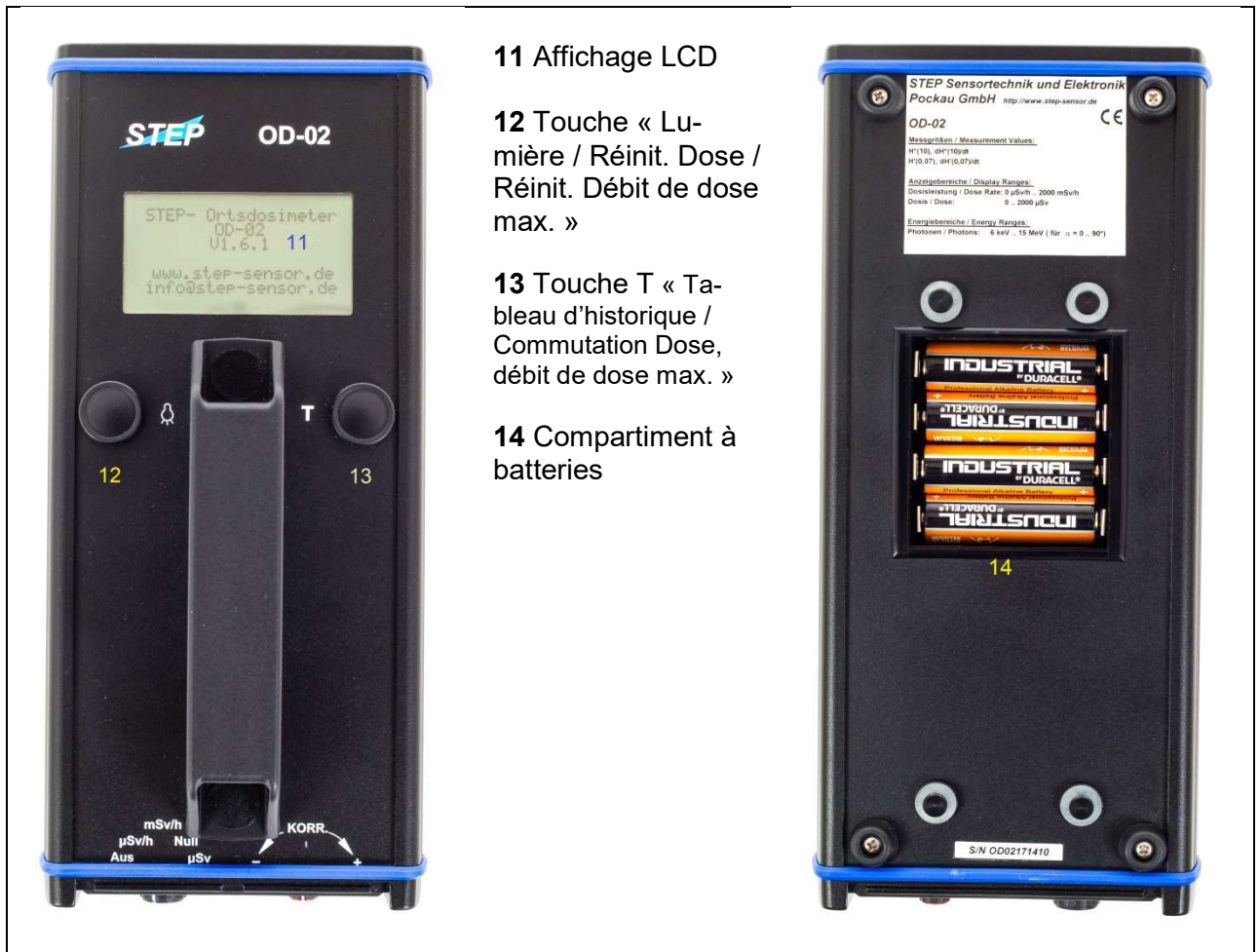
III. 3) Éléments de commande côté frontal et arrière
