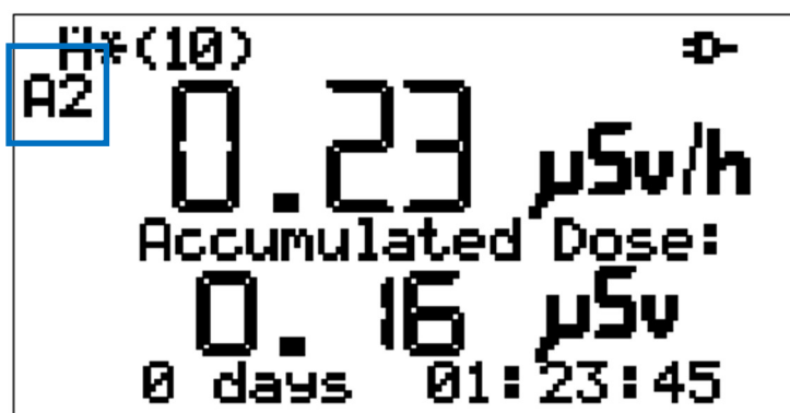
III. 29) Le seuil d'alarme A2 est atteint à ce moment (le symbole "A2" clignote)
