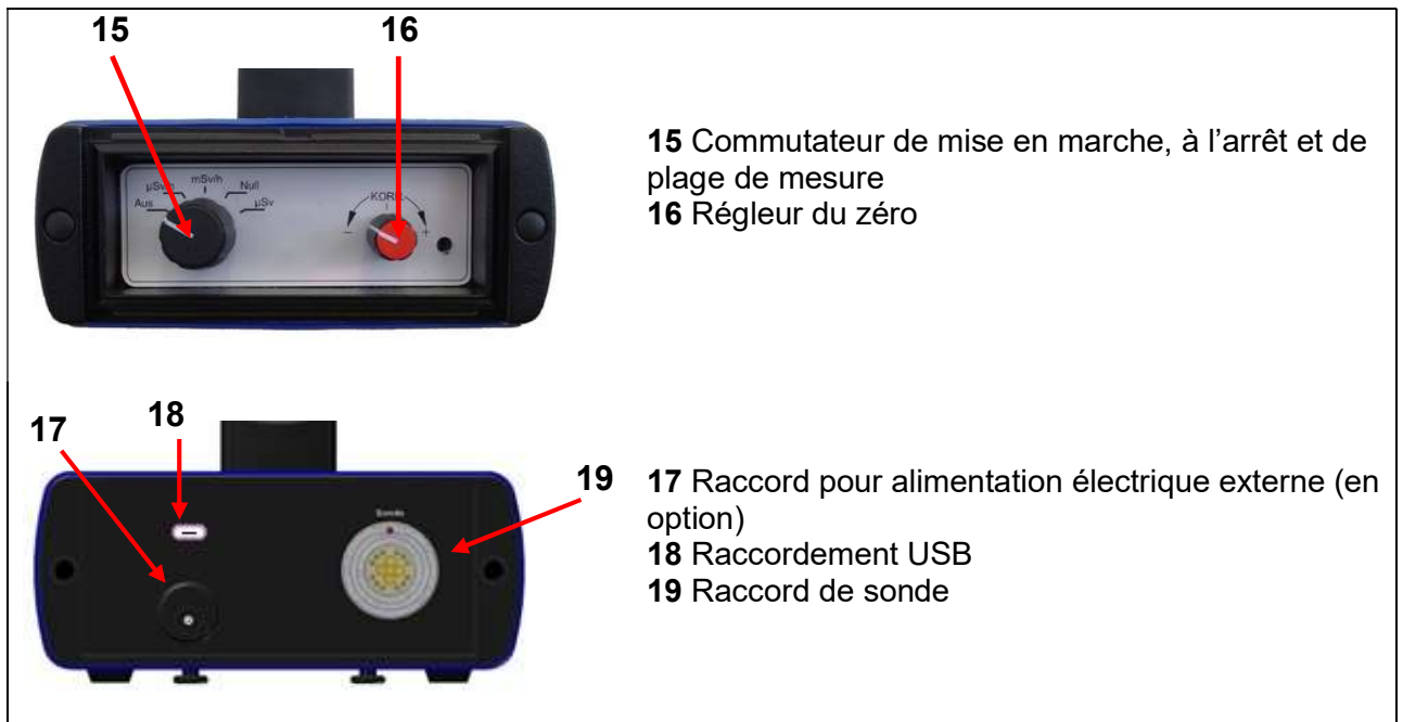
III. 4) Éléments de commande et raccords sur le côté frontal de l'appareil
