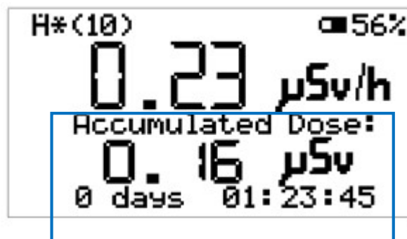
III. 7) Affichage de la dose accumulée en mode de débit de dose
