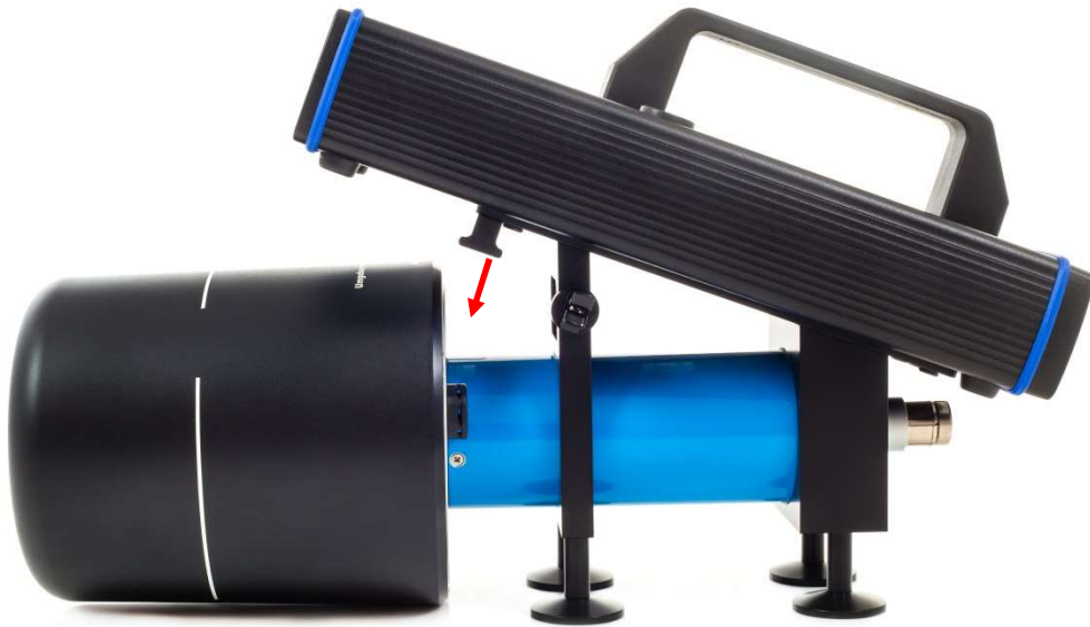
III. 22) Déverrouillage de la pièce d'affichage au porte-outils.
