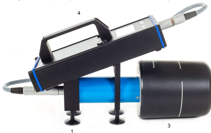
III. 20) Partie d'affichage et sonde enclenchées sur le porte-outils.
